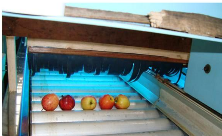
Figura 7. Tratamiento con radiación UV-C en combinación con hipoclorito de sodio ( \text{NaClO} ) en planta de packing de manzana (Fuente: Dra. Rosa María Valdebenito, Brasil)
