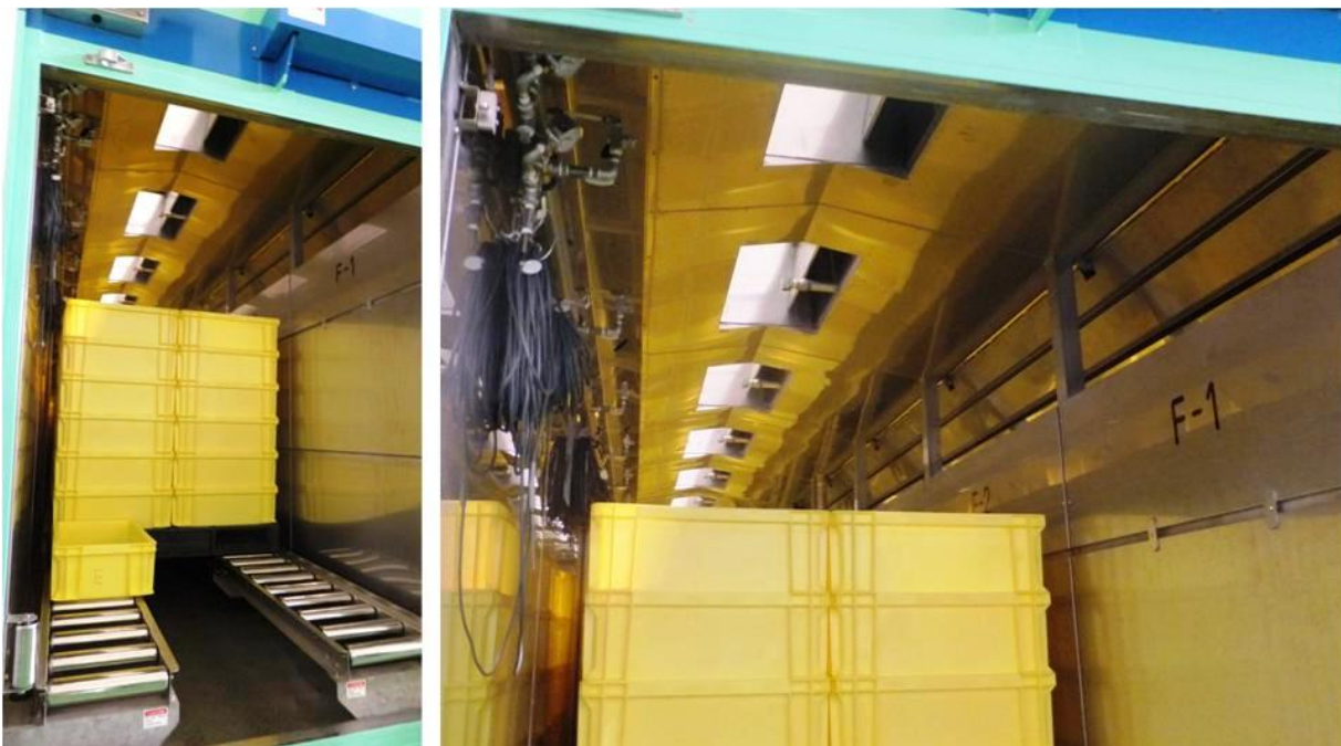
Figura 5. Tratamiento térmico mediante vapor (Fuente: Dra. Ana Silveira).
