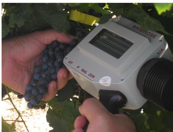
**Figura 4.** Espectrofotómetro portátil NIR de la casa comercial BRIMROSE en aplicación en viña (Fuente: Blanco et al., 2009)
