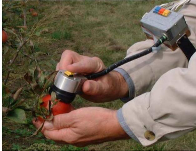
**Figura 2.** Detalle del pequeño espectrofotómetro, la fibra, y la cabeza de la sonda que se aplica al fruto del equipo implementado en manzana (Fuente: Herold et al., 2005).
