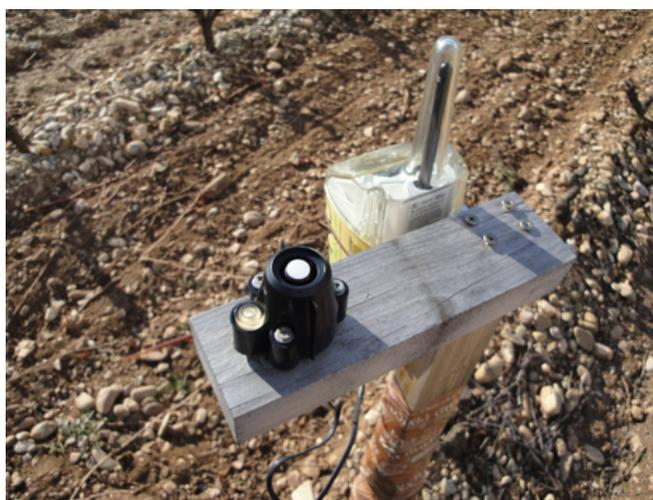
**Figura 12.** Sensor de radiación conectado a un nodo inalámbrico en la supervisión de las condiciones de cultivo de una viña (Fuente: Fernández, 2012)
