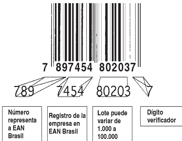
FIGURA 4. Ejemplo del código de barra EAN 13.
